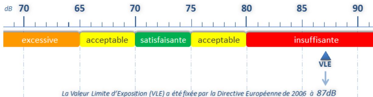
Figure 5 : Niveaux effectifs à l'oreille avec affaiblissement du PICB selon l'EN458
