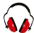
Appelé également serre-tête, serre nuque ou à coquilles, il peut être soit indépendant soit monté sur casque de sécurité industriel. Il est positionné « autour » de l'oreille, il est relié par un arceau passant au dessus de la tête. Il est de type réutilisable, il est conseillé de changer les coussinets (oreillettes) tous les ans pour assurer une bonne étanchéité.
