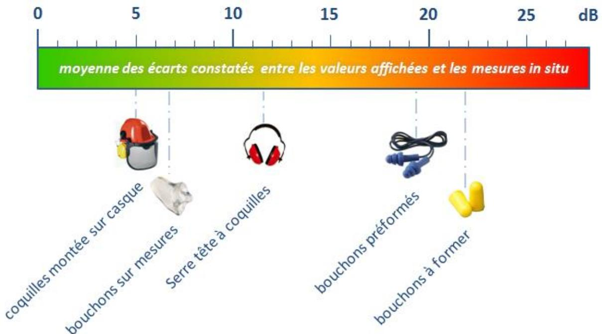
Figure 13 : moyenne des écarts constatés entre les valeurs affichées et les mesures in situ (en décibels)
