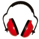
Der Kapselgehörschutz kann allein oder aber an einem Helm montiert getragen werden. Er wird „um das Ohr herum“ positioniert und ist mit einem Bügel, der über den Kopf getragen wird verbunden. Der Kapselgehörschutz gehört zu den wiederverwendbaren Gehörschützern. Allerdings sollten die Dichtungskissen mindestens jedes Jahr gewechselt werden, um eine gute Dichtigkeit zu gewährleisten.
