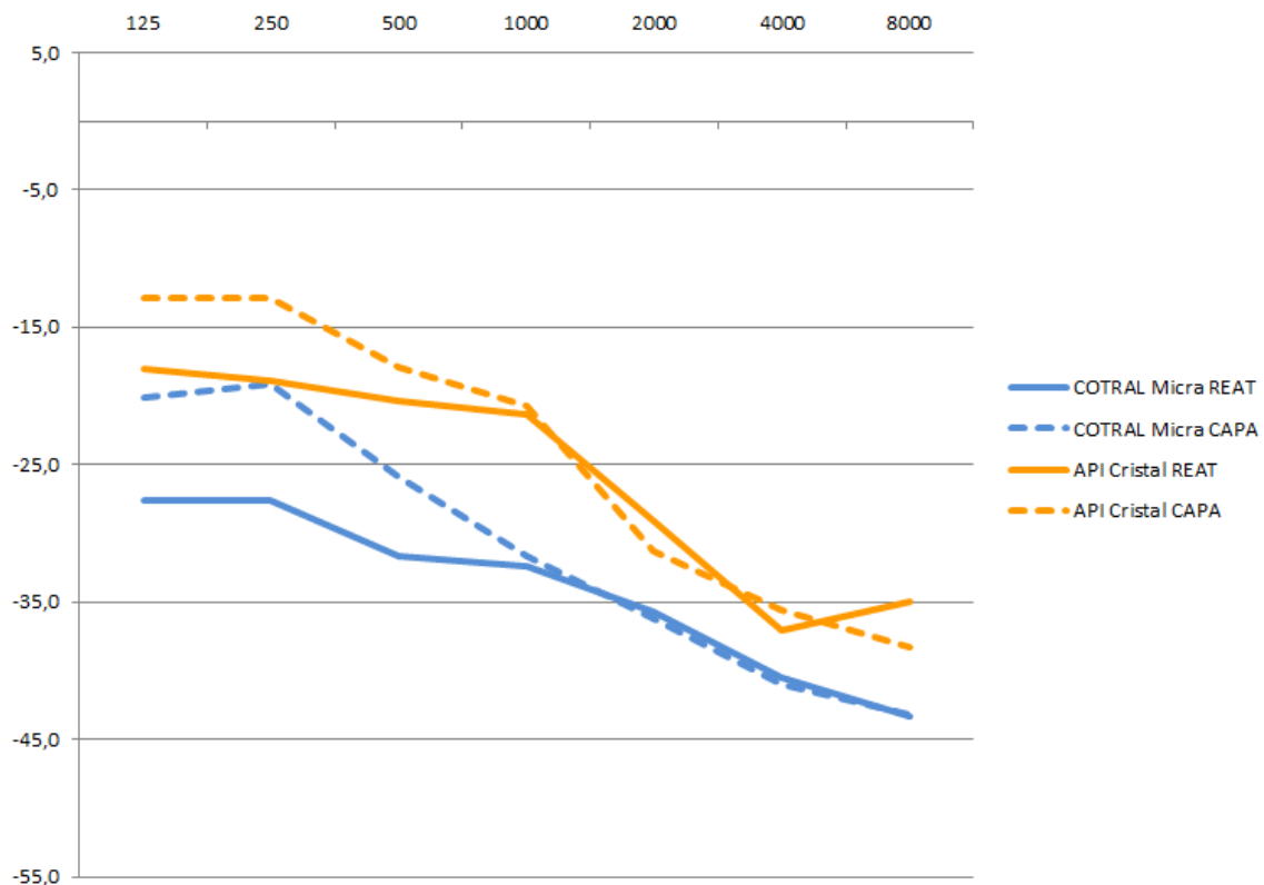
Abbildung 1: Vergleich der Messungen des CAPA-Systems mit Referenzwerten der REAT-Methode für zwei Gehörschutz-Otoplastiken COTRAL Micra und API Cristal. Beide Gehörschützer wurden für den Test verschlossen und müssten theoretisch die gleiche Dämmung aufweisen. Man kann jedoch eine Abweichung in der Wirksamkeit von einem Hersteller zum anderen feststellen. Der Cotral-Gehörschutz erhält eine Dämmung von ca. 10 dB über den von API indem der Referenzwert SNR gemäß der REAT-Methode gemessen wurde.
